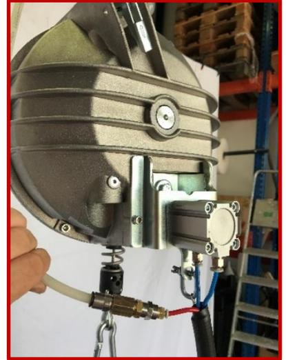
El Bloqueo neumático de **RESISTEC** permite controlar la carrera del equilibrador para la Serie 943X de una forma fácil y sencilla mediante un mando. Este incorpora un interruptor que actúa a al bloqueo del equilibrador mediante un cilindro.
