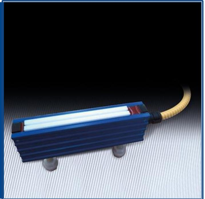
Esta barra generadora de carga estática está construida para equilibrar individualmente cada uno de los emisores gracias al resistor montado en cada uno de ellos. Esto nos permite que en caso de salto de arco el generador no se detenga para resetearse.
