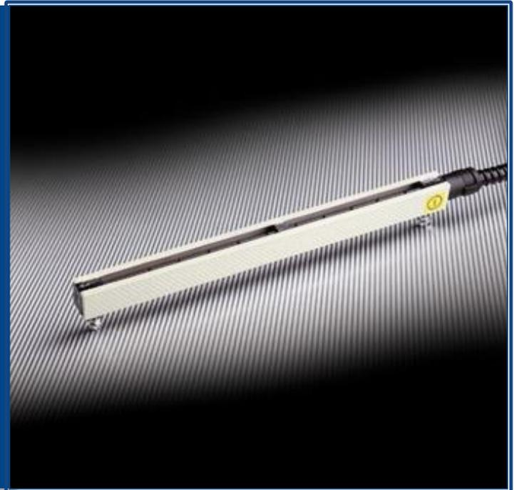
Se utilizan habitualmente en máquinas de producción donde es posible una ionización de corto alcance. Cada emisor individual de esta barra rectangular está acoplado capacitivamente a la alta tensión. De esta forma no se percibe calambre al tocar los emisores.
